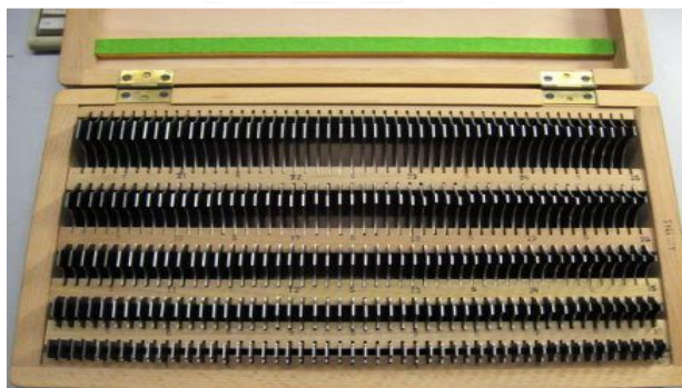
Obr. č. 3: Poloměrové šablony dle ON 25 3812 Výrobce: Zbrojovka Vsetín
