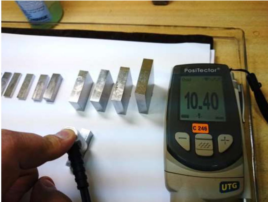
Obrázek č. 7: Měření chyb ultrazvukového tloušťkoměru
