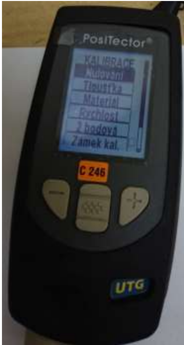
Obrázky č. 4 a č. 5: Nulování ultrazvukového tloušťkoměru k vestavěné měřce
