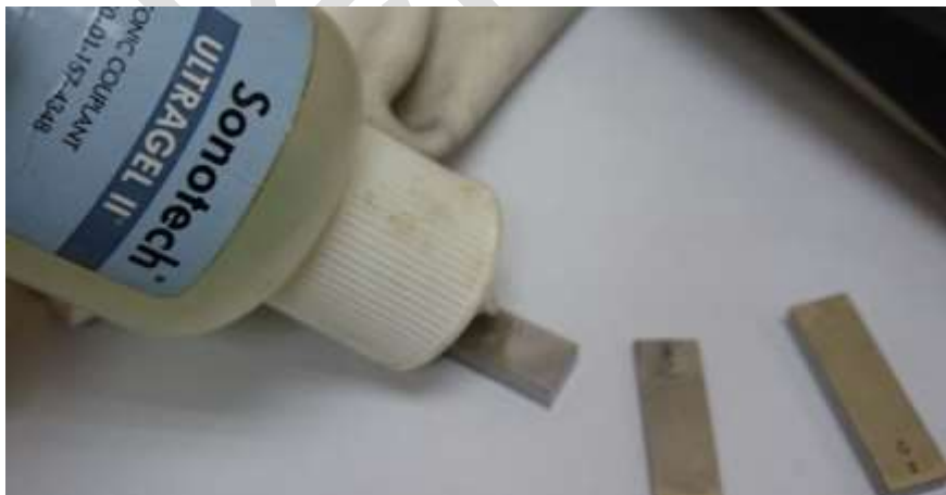
Obrázek č. 8: Nanesení sonické kapaliny
