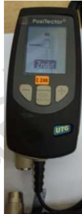
Obrázky č. 4 a č. 5: Nulování ultrazvukového tloušťkoměru k vestavěné měřce
