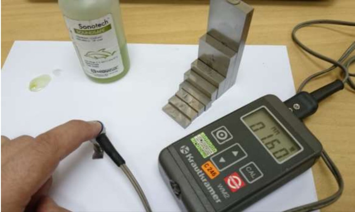
Obrázek č. 9: Měření chyb ultrazvukového tloušťkoměru
