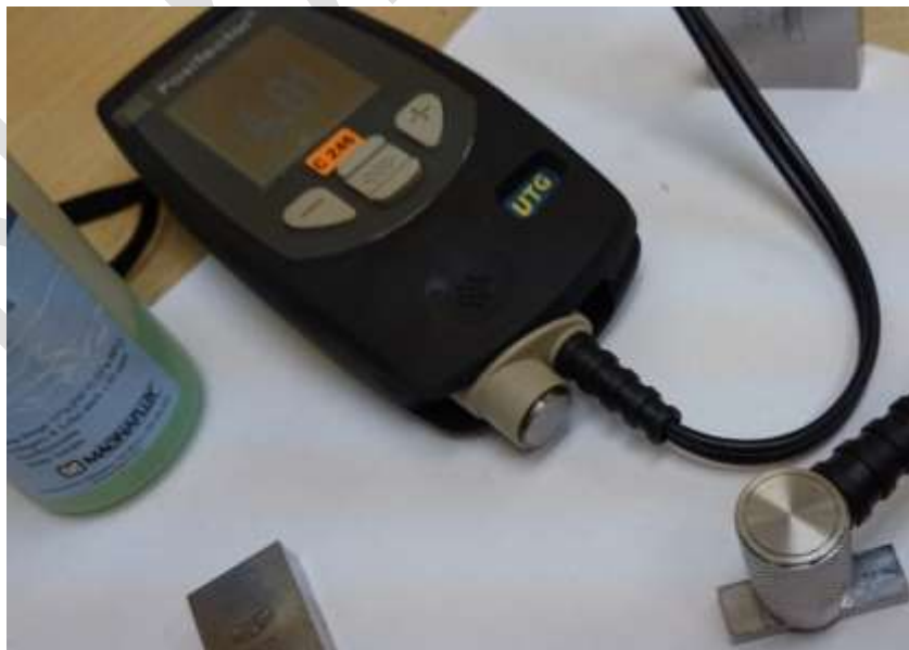
Obrázek č. 6: Kontrola na koncovou měřku 4 mm, odečtená hodnota je 4,01 mm.
