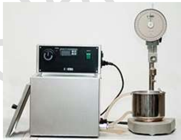
Obrázek č. 3: Sestava pro kontrolu asfaltových směsí
