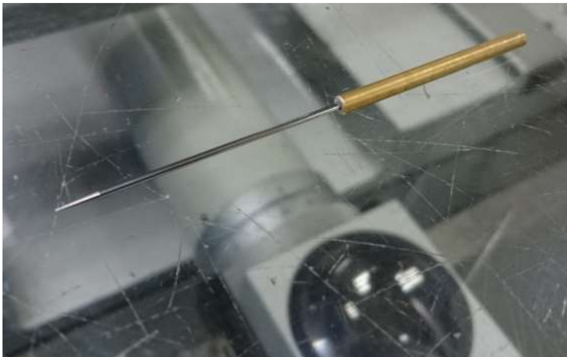
Obrázek č. 5: Kalibrace penetrační jehly mikroskopem
