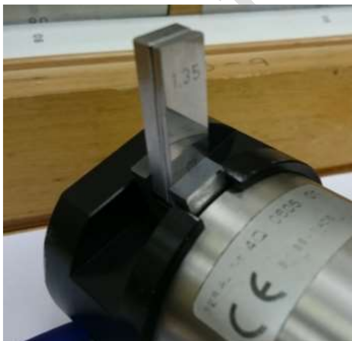
Obr. č. 8: Měření drážky kalibru, rozměr 6,35 mm.
