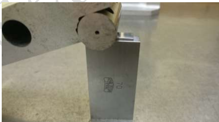
Obr. č. 11: Nastavení úhlu u sinusového pravítka.
