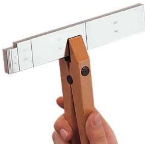
Obr. č. 9: Vytvoření plochého kalibru složeného z většího počtu měrek
