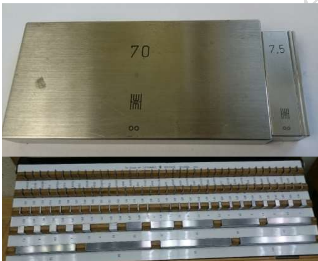
Obr. č. 6: Příklad složeného rozměru ze čtyř koncových měrek
