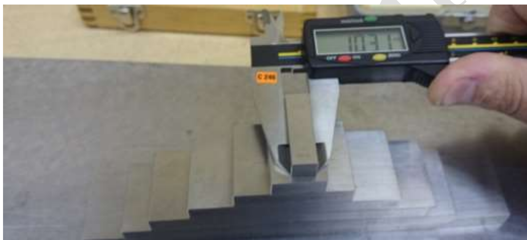
Obr. č. 10: Použití pro kalibraci dílenských měřidel.
