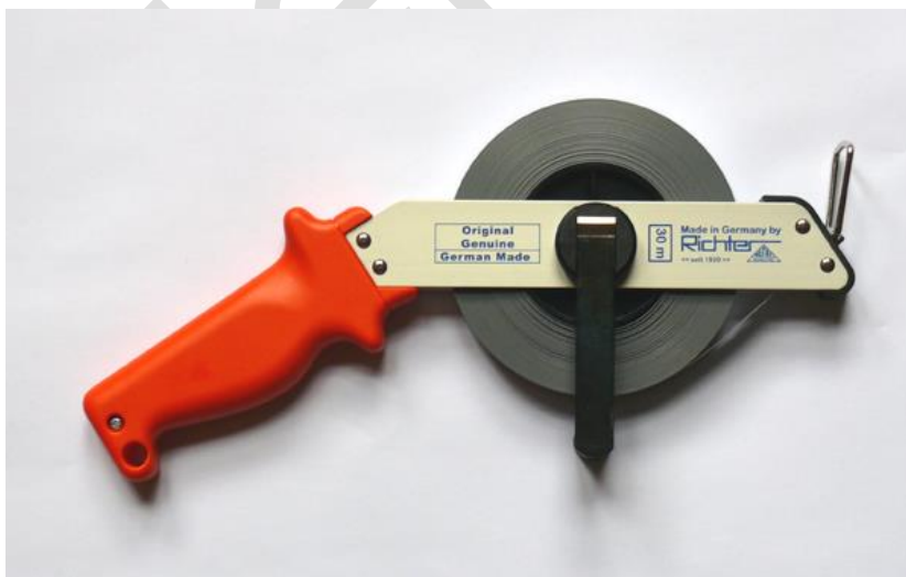
Obr. č. 1 Pásmo ve vidlici Výrobce: Richter Třída přesnosti II
