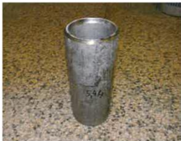
Obr. 6 - Ocel 08CH18N10T, trubka \varnothing 133 \times 13 mm, délka 250 mm
