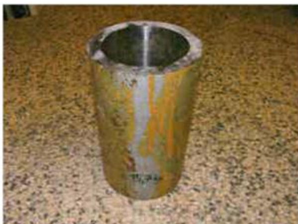
Obr. 5 - Ocel 22K, trubka \varnothing 150 \times 15 mm, délka 250 mm
