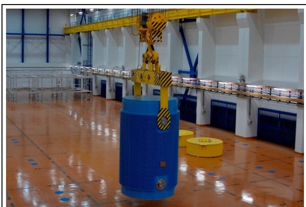
Kontejner Castor 440/84M při manipulacích v SVP. Zdroj: ČEZ
